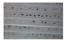
Wärmetauscherlamellen einer Wärmerückgewinnung mit schlechter Abluftfiltrierung. Die Folge ist ein plötzlicher Anlageausfall und eine aufwendige Reinigung, sofern diese überhaupt möglich ist.
